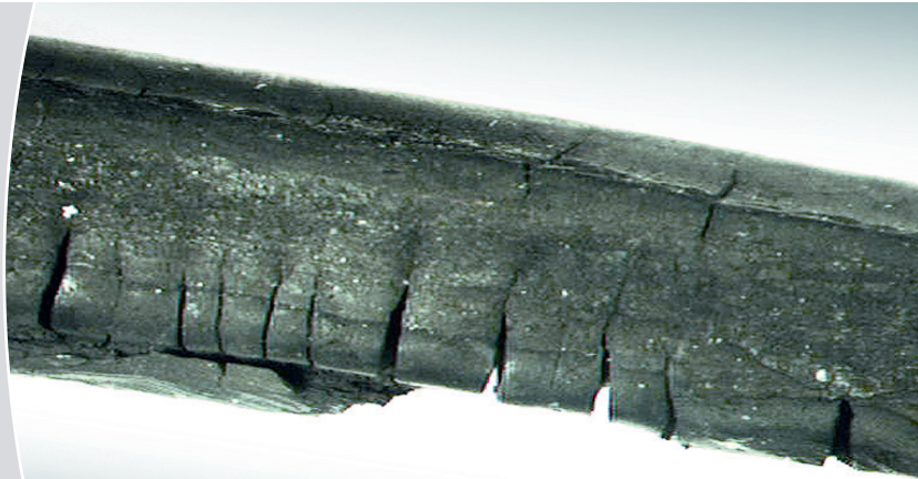
Extrem starker thermischer Angriff auf einen O-Ring
